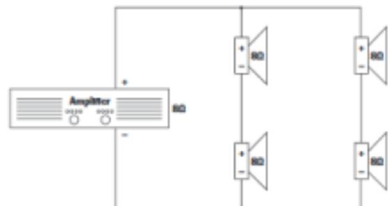
Il sistema con linea 100V può comprendere molti altoparlanti collegati insieme. Il fattore determinante sul numero di altoparlanti possibili è la potenza nominale. Per molti utilizzi è consigliato connettere gli amplificatori necessari con una potenza combinata non superiore al 90% della potenza nominale in uscita dall'amplificatore. I terminali di un amplificatore a 100V sono connessi a un trasformatore e in alcuni casi può essere regolato per diverse potenze
